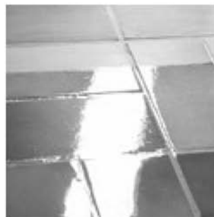
Fliesen vor (oben) und nach (unten) der Behandlung mit Fliesendicht.
